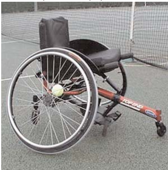
El diseño de una silla de ruedas para jugar al tenis es notablemente diferente pues facilita la habilidad de los jugadores para moverse y girar rápidamente.
