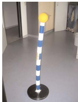
Figure 1. Dispositif pendulaire surmonté d'une balle pour la simulation des frappes.
