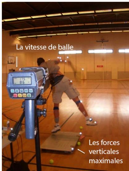
Figure 1. Les forces verticales maximales et la vitesse de balle après l'impact ont été déterminées respectivement au moyen d'une plateforme de force et d'un radar.
