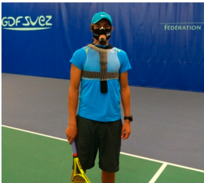
Photo 1 : Équipement du joueur avec le système de mesure des échanges gazeux lors du TEST.
