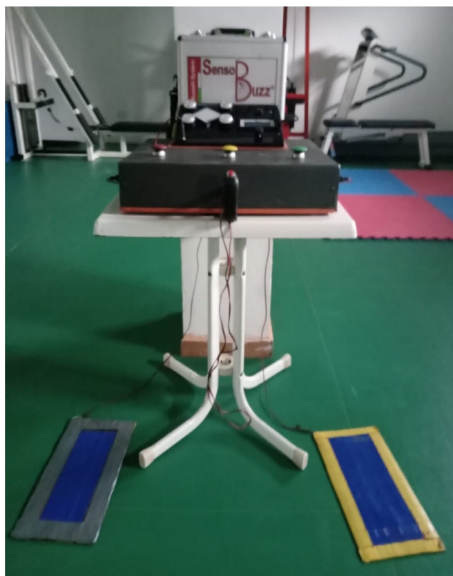
Figure 1. La figure montre la console SensoBuzz utilisée pour évaluer les temps de réaction simples et complexes.
