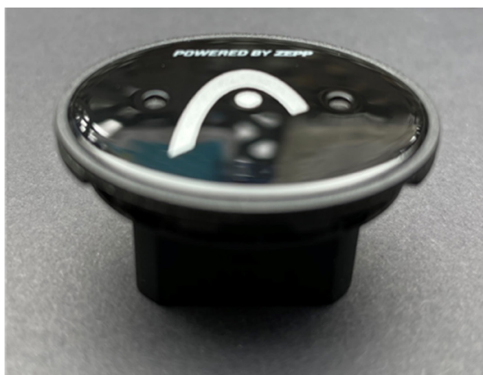
Figura 1. Sensor de análisis de movimiento montado en la raqueta de tenis (HEAD Tennis Sensor; ZEPP).
